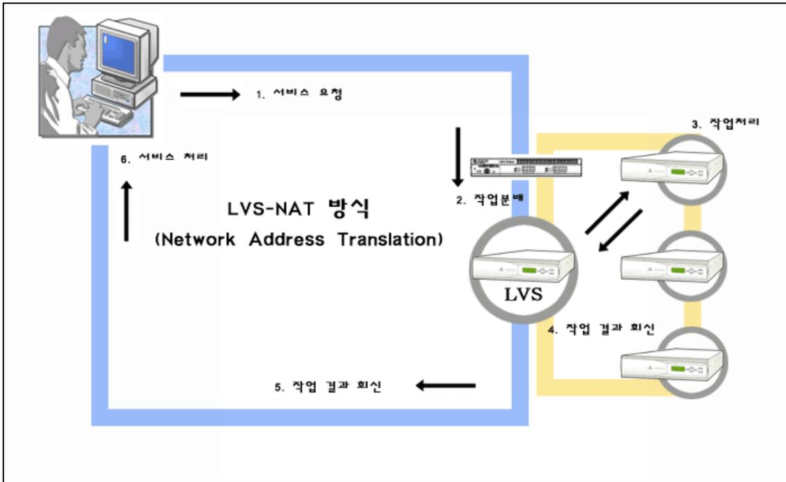
사용자가 LVS 에서 가지고 있는 VIP 를 향해 서비스 요청을 하면 LVS 에서는 그 서비스 요청된 IP 와 Port 가 가상 서버 정책에 있는지를 확인하고 있다면 이 정책에 정해진 스케줄에 따라 실제 작업 서버로 패킷을 포워딩 시키게 된다. 이때 LVS 서버는 사용자가 요청한 패킷의 네트워크 주소 부분을 공인 IP 에서 사실 IP 로 주소를 변환 시켜 같은 사설망에 존재하는 작업 서버로 보내게 된다. 작업서버는 LVS 서버로부터 패킷을 전달 받고 이에 대한 요청 처리된 내용을 다시 LVS 에 보내게 된다. 그럼 LVS 가 사실 IP 로 된 패킷을 다시 받아 다시 공인 IP 로 주소를 변환시켜서 사용자에게 돌려 보내는 방식이다.
